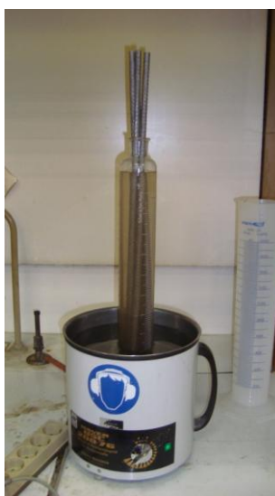
Figuur 3-3: Plaatsen van de wapening in het ultrasoon bad.
