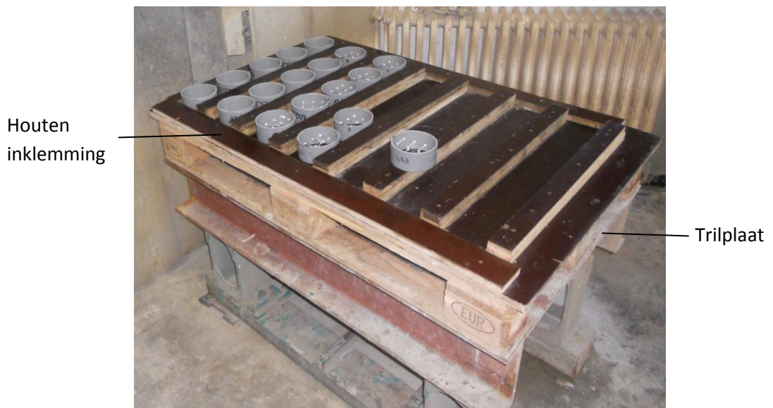
Figuur 3-2: Inklemming van de mallen op de triltafel.
