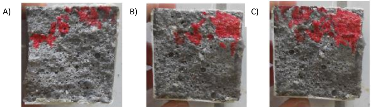
Figuur 4-11: Illustratieve reconstructie van het PU in de scheur voor een proefstuk uit reeks MAN BASF 2.
